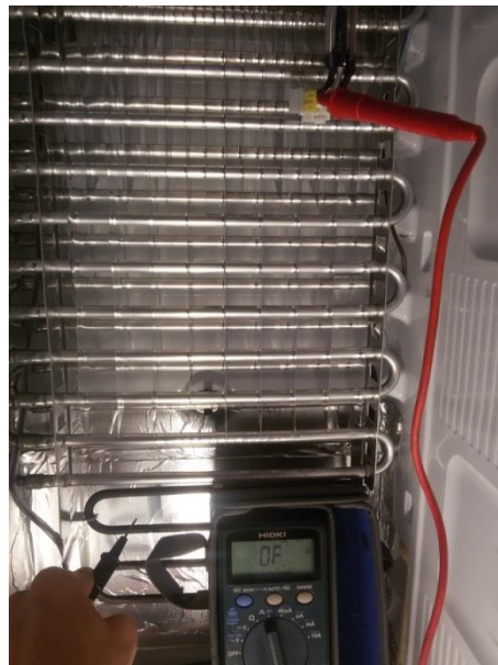
بررسی وضعیت اتصالی سر اول سیم ترموفیوز به بدنه
